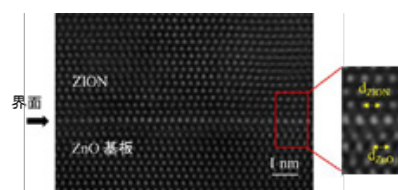
図3 O 極性面上 ZION 膜の高分解能 TEM 観察結果。
